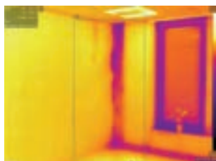
▲ Alarõhu olukorras tehtud termopildid, mis viitavad õhuleketele paneelide liitekohtades.
