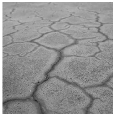
PILT 1: (a) plastse kahanemise praod päikese käes kuivanud mudal; (b) plastse kahanemise praod kivinenud betoonil.
