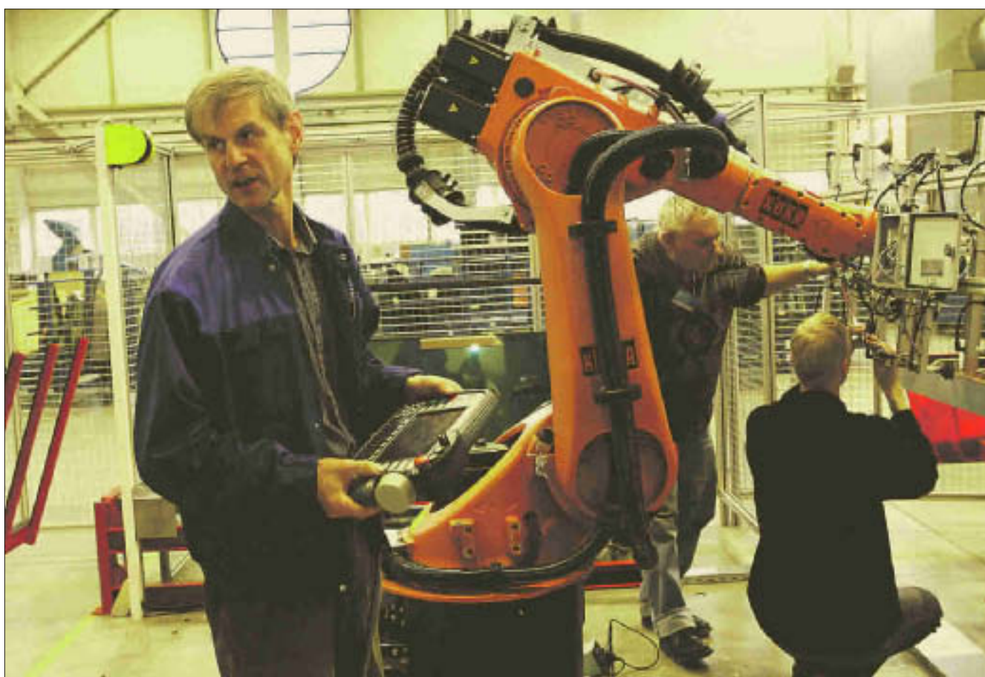
► Saint-Gobain Sekurit Eesti IT-spetsialist Toivo Põld häälestab spetsiaalse puldi abil uut Kuka robotit, mille ülesandeks hakkab olema kindla ajavahemiku järel laost tooriklaasi lõikeliinile tõstmine.
