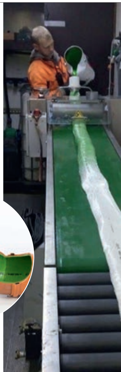
▲ Spetsiaalne vaiku abil kivistuv renoveerimismaterjal võimaldab ehitada vanade torude sisse uue torustiku seinu maha lõhkumata. FOTOD: TERRAT
