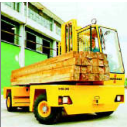
Uus Baumanni külglaadimistõstuk suudab tõsta kuni neli tonni.
