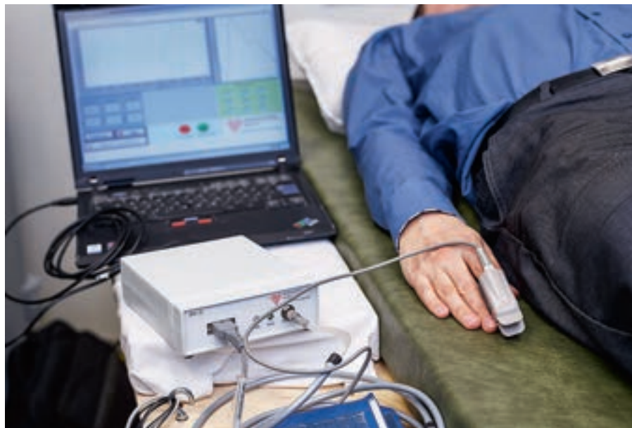
TTÜs välja töötatud pulsiline analüsaator kinnitatakse EKG tegemise ajaks inimese sõrme külge. Ekraanilt võib näha pulsiline kuju.
