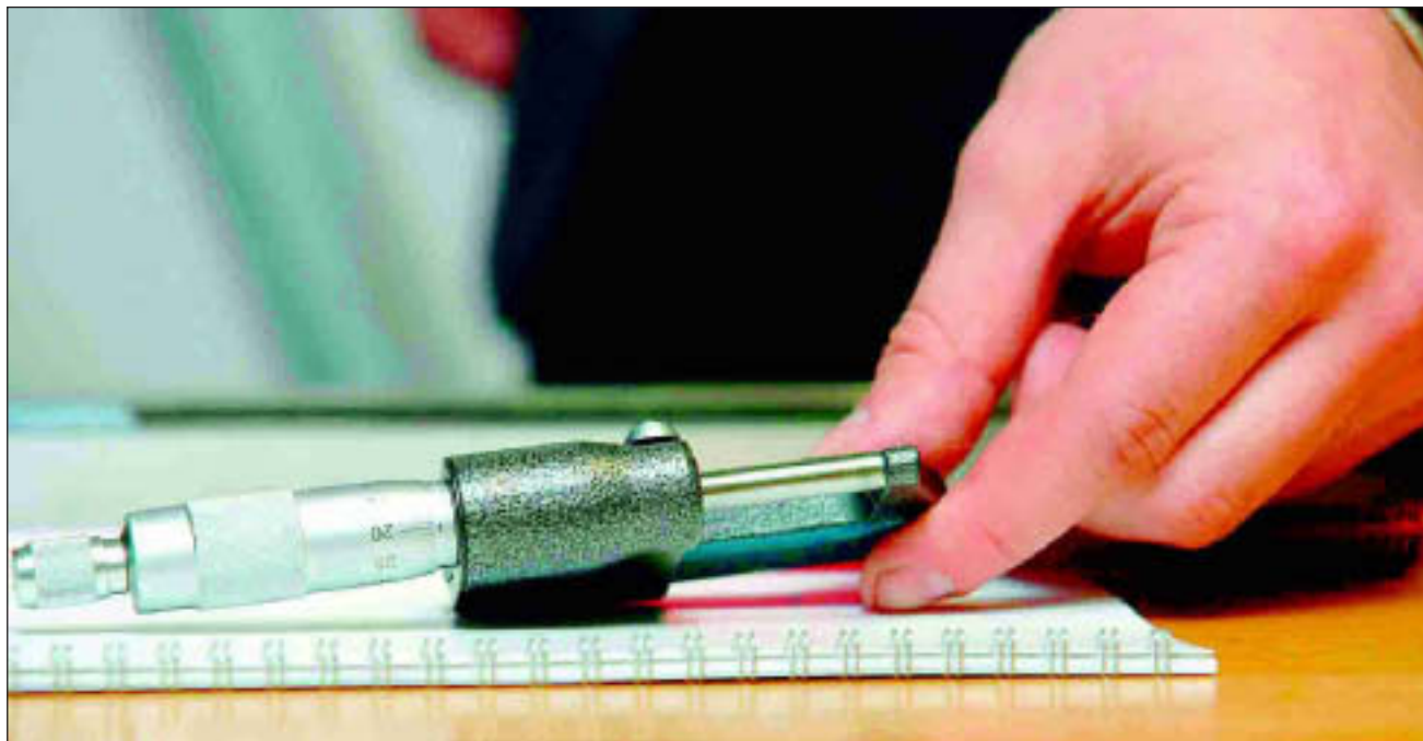
Rahvusvaheliselt kasutatavad mõõtetulemused peavad olema ülitäpsed, sestap on tarvis kasutada üldiselt tunnustatud riistu. Pildil käib juuksekarva jämeduse mõõtmine.
