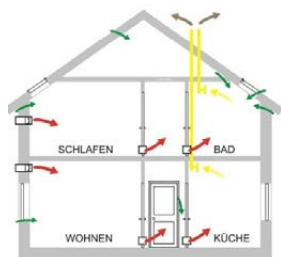
Joonis 24. Šahtventilatsiooni skeem.
