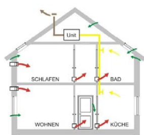
Joonis 25. Väljatõmbega mehaanilise ventilatsiooni skeem.
