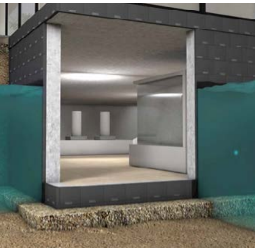
Vahtklaas sobib survealuse veega maa-aluste tarindite soojustamiseks.
