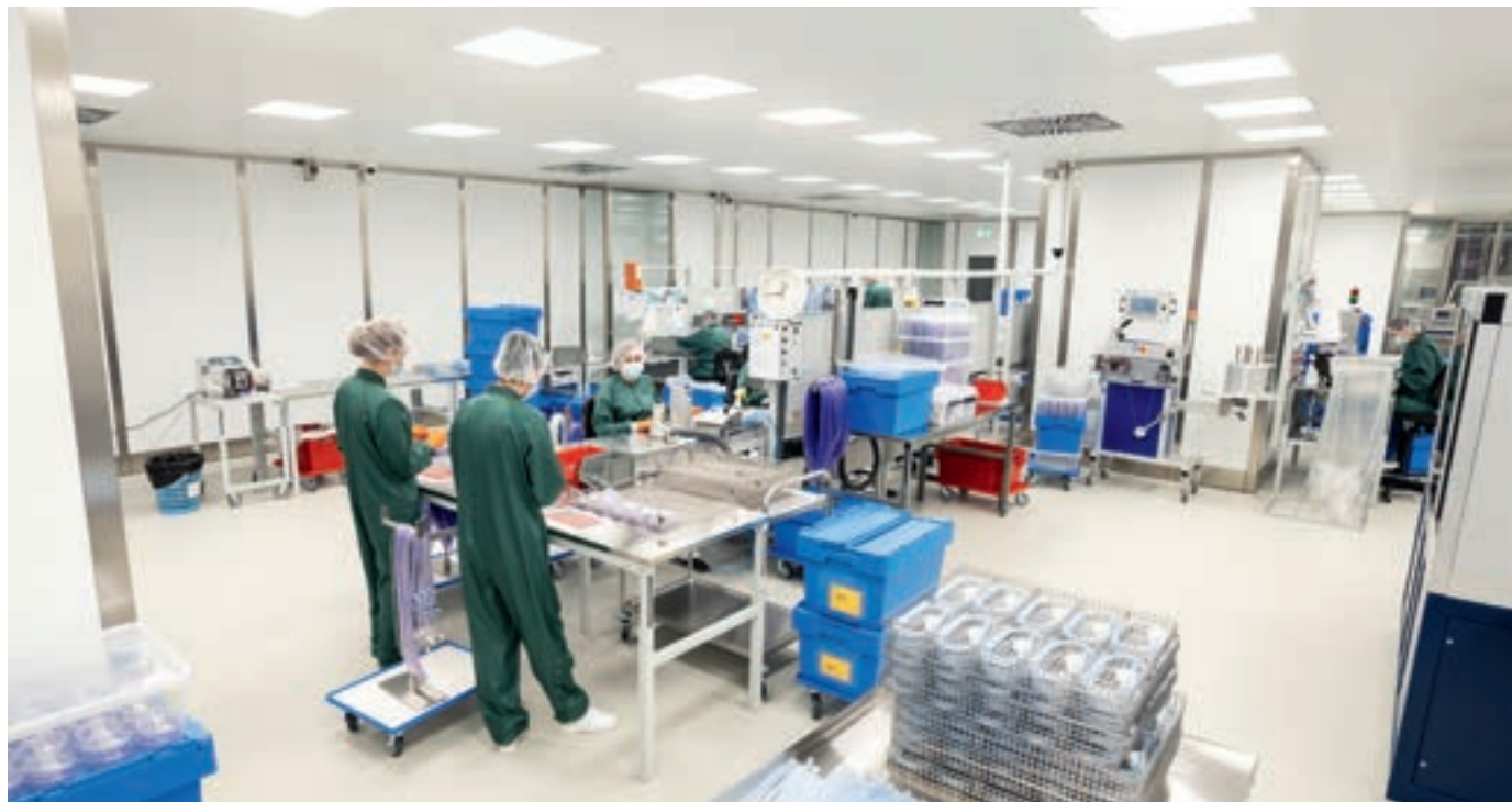
Puhasruumis on nõuded saaste vältimiseks väga kõrged, mis tähendab eririietust, võimsat ventilatsiooni, niiskusekontrolli ning erirežiimi sisenemisel ja väljumisel.
