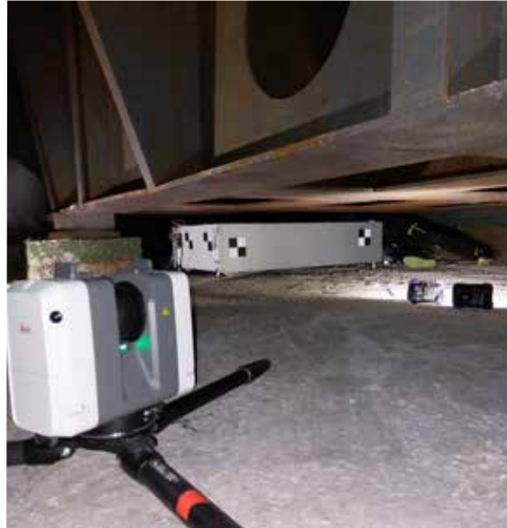
Paldiski tuumareaktori kaardistamine tuumaohutuse firma AS A.L.A.R.A. tellimusele: ülemine on reaktor, selle all poolemeetrises vahes on müüondetektor ning Andres Nurme operaatore rollis. Juuni 2023.
